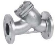
ANSI, JIS, DIN, GB Flanged Strainers (CF8, CF8M) ANSI-1/2"~28" / 150LB~300LB JIS- DN15~700 / 10K~20K DIN- DN15~700 / PN16~40 GB- DN15~7500 / PN16~40 YS41W6F/150
