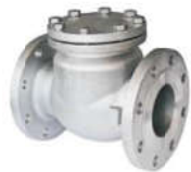
ANSI, JIS, DIN, GB Flanged Check Valve (CF8, CF8M, WCB) ANSI- 1/2"~20" / 150LB~300LB JIS- DN15~500 / 10K~20K DIN- DN15~500 / PN16~63 GB- DN15~500 / PN16~63
